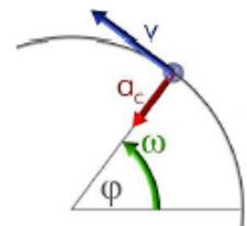
En el *movimiento circular* vamos a relacionar magnitudes lineales y angulares. Para establecer una relación entre el ángulo y el arco se define el *radian*. Un **radian** es el ángulo de una circunferencia que abarca un arco de igual longitud que el radio de la misma.
