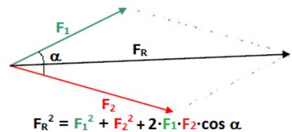
En el caso especial, y frecuente, de tener que sumar dos *vectores perpendiculares*, podemos calcular el *módulo* de la *fuerza resultante* usando el *teorema de Pitágoras*:
