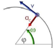
En el *movimiento circular* vamos a relacionar magnitudes lineales y angulares. Cuando el *móvil* recorre la trayectoria desde  $P_1$  a  $P_2$  (arco de circunferencia) el radio barre el ángulo  $\varphi$ . El ángulo se mide en *radianes* y el arco en metros.
