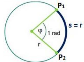
Para determinar el ángulo  $\varphi$ , en radianes, de un arco de longitud  $s$  en una circunferencia de radio  $r$  utilizaremos la expresión:  $\varphi = s/r$ .
