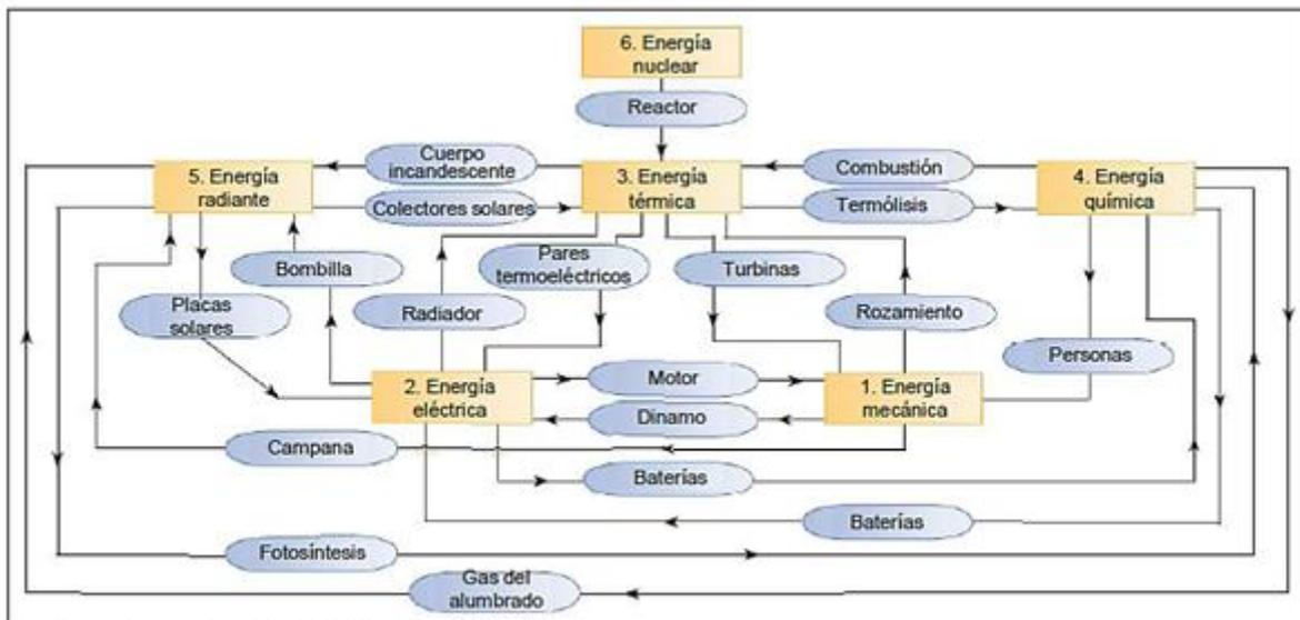
Transformación de la energía y máquinas utilizadas.
