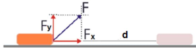
que se realiza es debido a la componente  $F_x$  de la fuerza en la dirección paralela al movimiento. La componente  $F_y$  de la fuerza, que es perpendicular al desplazamiento, no realiza trabajo sobre el cuerpo.
