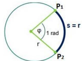
La **velocidad angular** en un *movimiento circular uniforme*,  $\omega$ , es la relación entre el ángulo  $\varphi$ , medido en radianes y el tiempo que tarda en recorrerlo:  $\omega = \varphi/t$ . Su unidad es **rad/s**, aunque con frecuencia se utiliza otra unidad, **r.p.m.** (*revoluciones o vueltas por minuto*).
