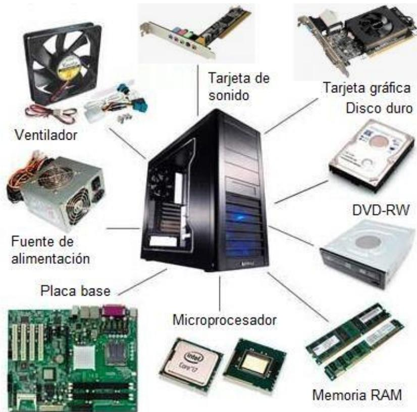
La caja necesita una **fuentes de alimentación** para dar corriente eléctrica y energía a todos los elementos del ordenador.
